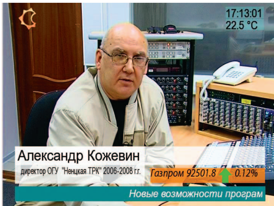
SYNADYN TV в эфире. Вещание с одновременным наложением графики – бегущей строки, логотипа, часов, температуры, статического текста
